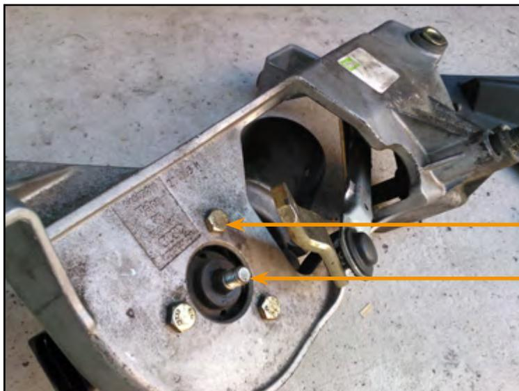
Nun versuchen die Wellen aus der Bohrung jeweils zu ziehen. Sollte es nicht klappen, weil diese darin zu sehr festsitzen, versuchen mit seeeeeeeeeehrr leichten (Gummi-)Hammerschlägen diese auszutreiben. Darauf achten dass sich das Gestänge nicht am Gehäuse verkantet.
