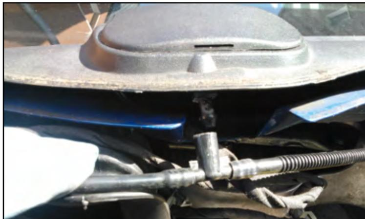
ODER man hebelt die Spritzdüsen komplett aus und nimmt nur die Plastikabdeckung ab
